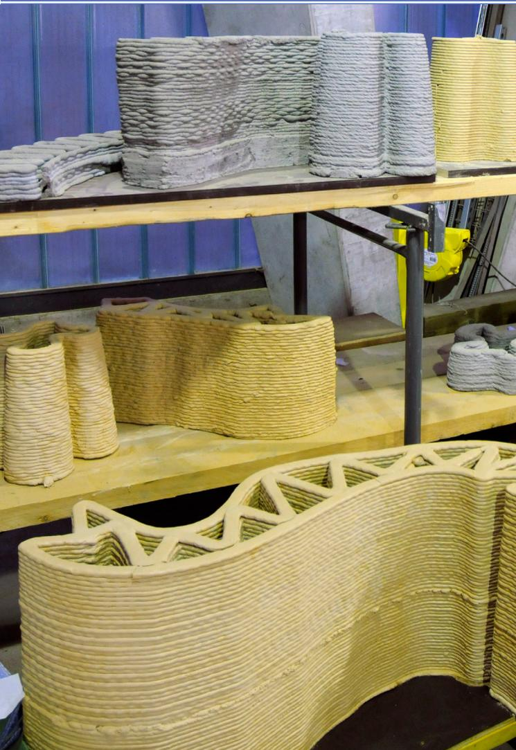
Vues de prototypes réalisés à l'aide d'une imprimante 3D dans le cadre du programme de recherche MATRICE (cl. Ensapl 2017)
