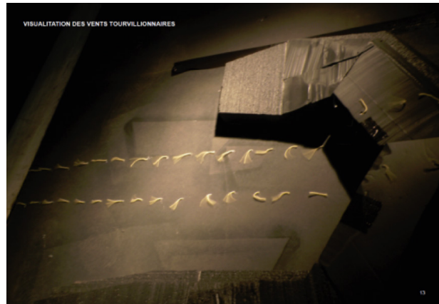
Fig.3. Evaluation des effets du vent sur la forme à l'aide de fil de laine (PFE de P.Flandrin)
