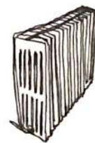
Radiateurs en fonte
